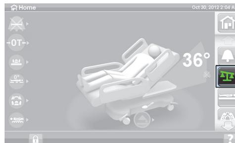
Un poids non vérifié est une mesure en temps réel du poids du patient et de tous les éléments présents sur la zone de pesée n'ayant pas fait l'objet d'une remise à zéro/tare. Pour vérifier le poids, retirez de la zone de pesée les éléments n'ayant pas fait l'objet d'une remise à zéro/tare et appuyez sur **Save Weight** (Sauvegarder poids).
