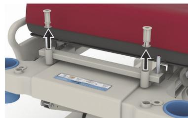
7. Sur le côté gauche du support de l'adaptateur de tête, appuyez sur le bouton pression pour installer le support de l'adaptateur de tête dans les embases pour l'équipement de traction. Assurez-vous que le support est complètement inséré dans l'embase.
