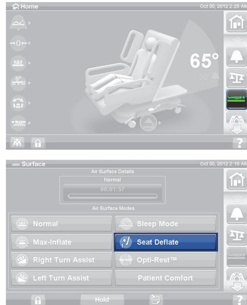
La superficie **Progressa** Therapy saldrá automáticamente del modo Seat Deflate (Desinflado del asiento) y volverá al modo normal después de 30 minutos. Después de 28 minutos, sonará un pitido y aparecerá una pantalla en la que se indicará que quedan 2 minutos.
