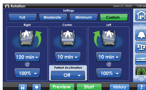
Οθόνη περιστροφής στρώματος Accelerate (P7540)
